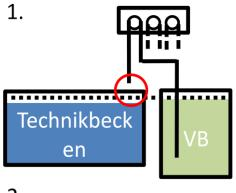
**Wichtig:** Die Dosierpumpe und Ihre Ausläufe sollten sich immer oberhalb der Vorratsbehälter befinden (1. und 2.). Der Auslauf sollte zudem nicht mit dem Aquarienwasser in Verbindung stehen (roter Kreis). Der insgesamt zu bewältigende Höhenunterschied sollte möglichst gering sein.
